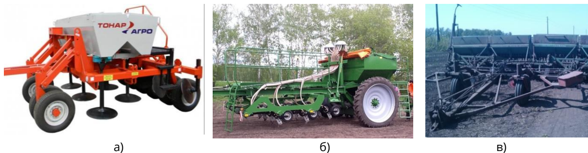
Рис. 2. Посевные машины: а – посевной комплекс ЭППК-2,5; б – посевной комплекс Condor; в – сеялка СЗП-3,6А
