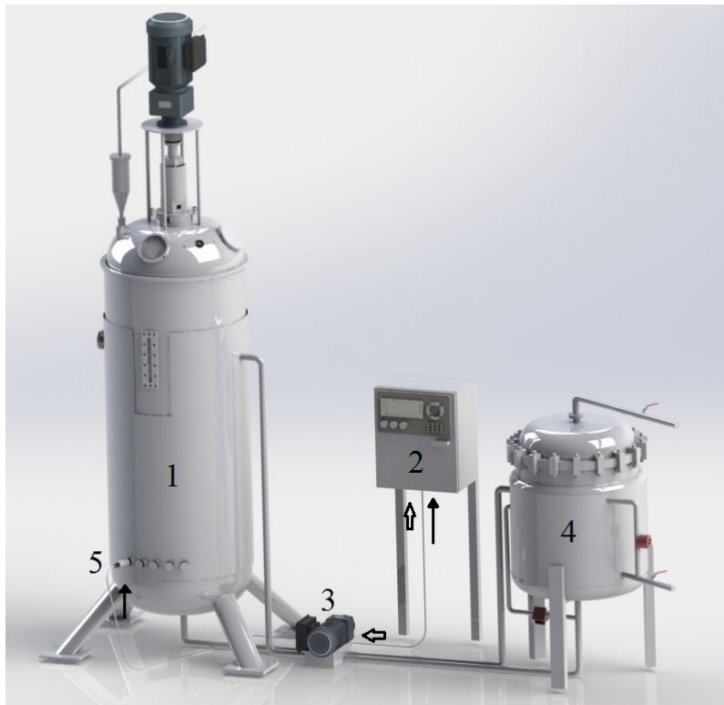
Рис 2. Контур удаления органических кислот из культуральной среды. 1-ферментер, 2 - рН-стат, 3 – циркуляционный насос, 4 – ультразвуковой мембранный экстрактор, 5- датчик рН.
